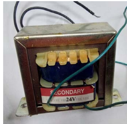
รูปที่ 4.4 ตรวจเช็คหม้อแปลงไฟฟ้า 220V เป็น 24V โดยการนำไปต่อกระแสไฟฟ้า 220V ใช้คลิปแอมป์วัดกระแสไฟฟ้าที่แปลงออกมาได้ 24 V
