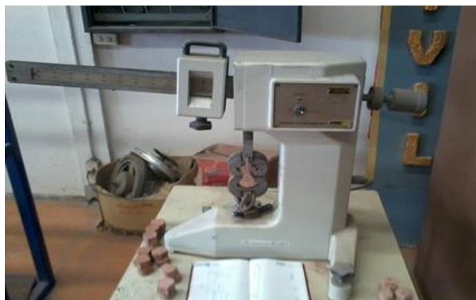
รูปที่ 3.8 ก้อนซีเมนต์เพสต์ผสมน้ำยางขณะทดสอบแรงดึง
