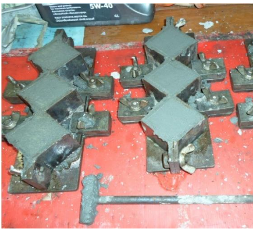
รูปที่ 3.5 แบบหล่อรูปลูกบาศก์และก้อนตัวอย่างทดสอบแรงอัด
