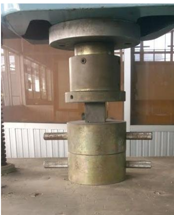
รูปที่ 3.5 แบบหล่อรูปลูกบาศก์และก้อนตัวอย่างทดสอบแรงอัด
