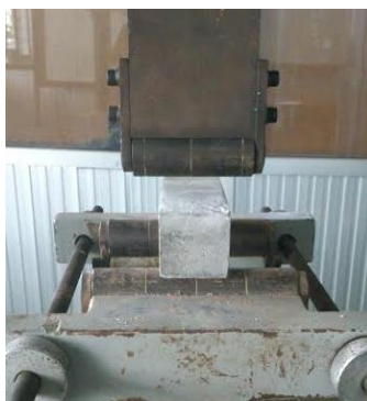
รูปที่ 3.7 ก่อนซีเมนต์เพสต์ผสมน้ำยางขณะทดสอบแรงดัด
