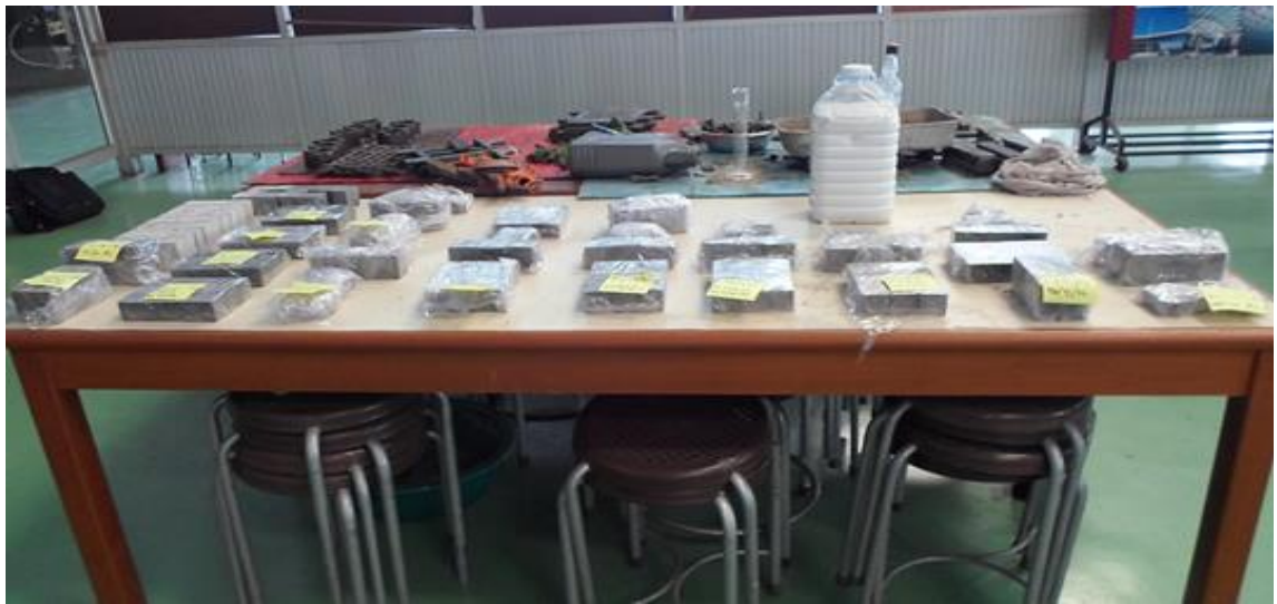
รูปที่ 3.3 ก่อนตัวอย่างทดสอบขณะบ่มด้วยพลาสติก
