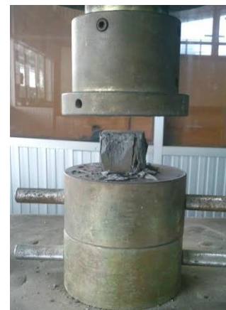
รูปที่ 3.5 แบบหล่อรูปลูกบาศก์และก้อนตัวอย่างทดสอบแรงอัด
