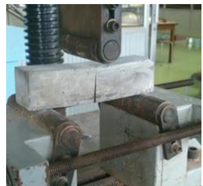
รูปที่ 3.7 ก่อนซีเมนต์เพสต์ผสมน้ำยางขณะทดสอบแรงดัด
