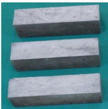
รูปที่ 3.7 ก่อนซีเมนต์เพสต์ผสมน้ำยางขณะทดสอบแรงดัด
