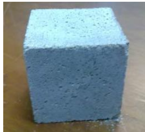
รูปที่ 3.5 แบบหล่อรูปลูกบาศก์และก้อนตัวอย่างทดสอบแรงอัด
