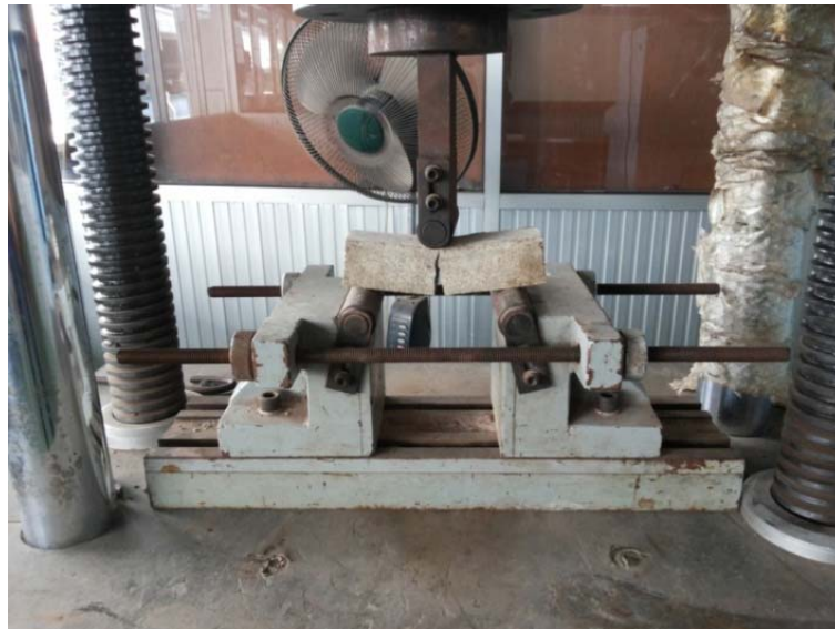
ปที่ 40 แสดงการทดสอบการรับแรงคัต
