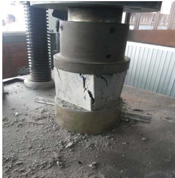
รูปที่ 38 แสดงผลการทดสอบการรับแรงอัด
