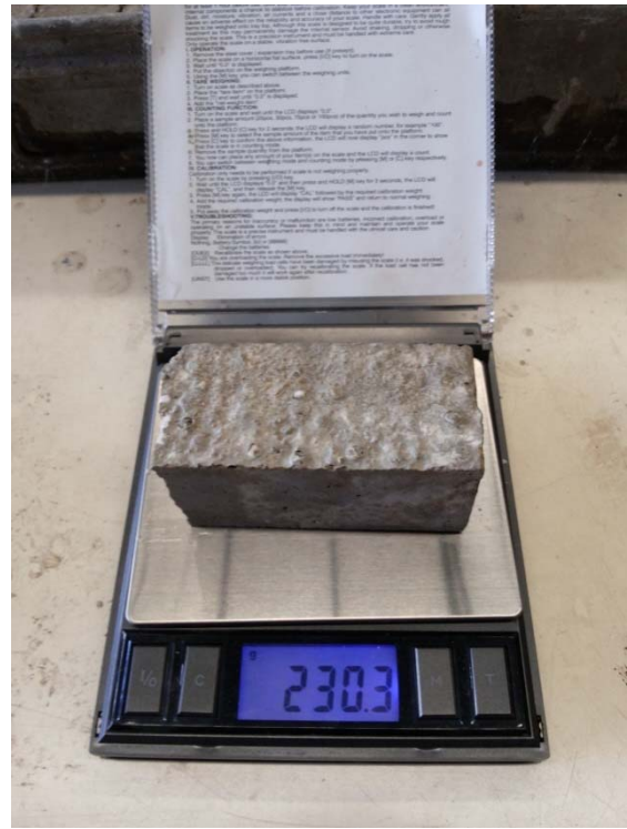
รูปที่ 45 ลักษณะการทดสอบการดูดซึมน้ำ
