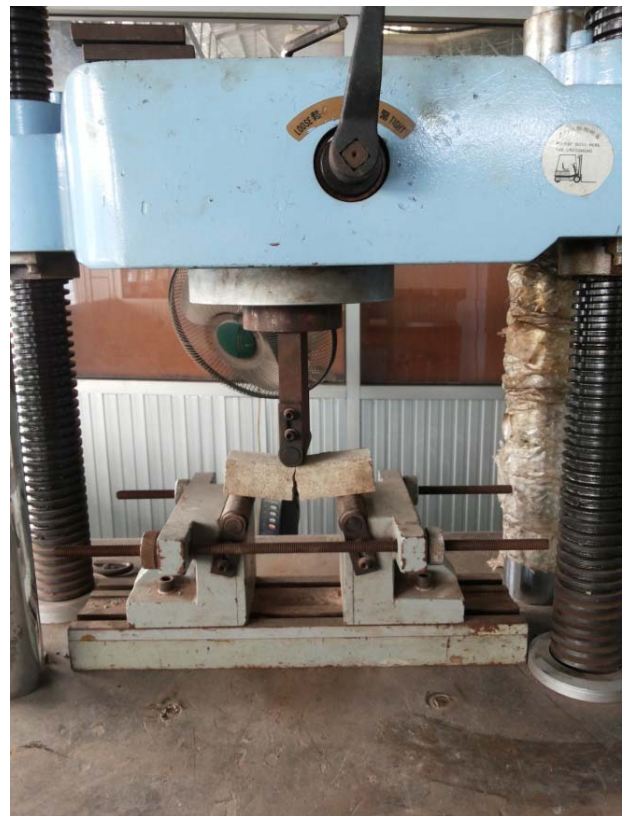
รูปที่ 44 ลักษณะการพังทลายของมอร์ตาร์ผสมโฟม EPS กำลังรับแรงค้ำ
