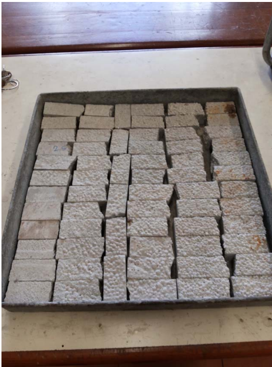
รูปที่ 45 ลักษณะการทดสอบการดูดซึมน้ำ
