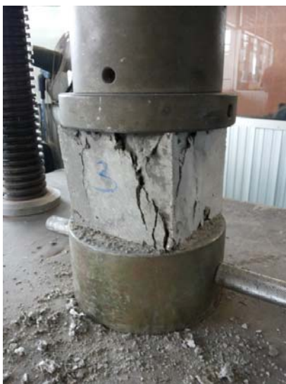
รูปที่ 43 ลักษณะการพังทลายของมอร์ตาร์ผสมโฟม EPS กำลังรับแรงอัด
