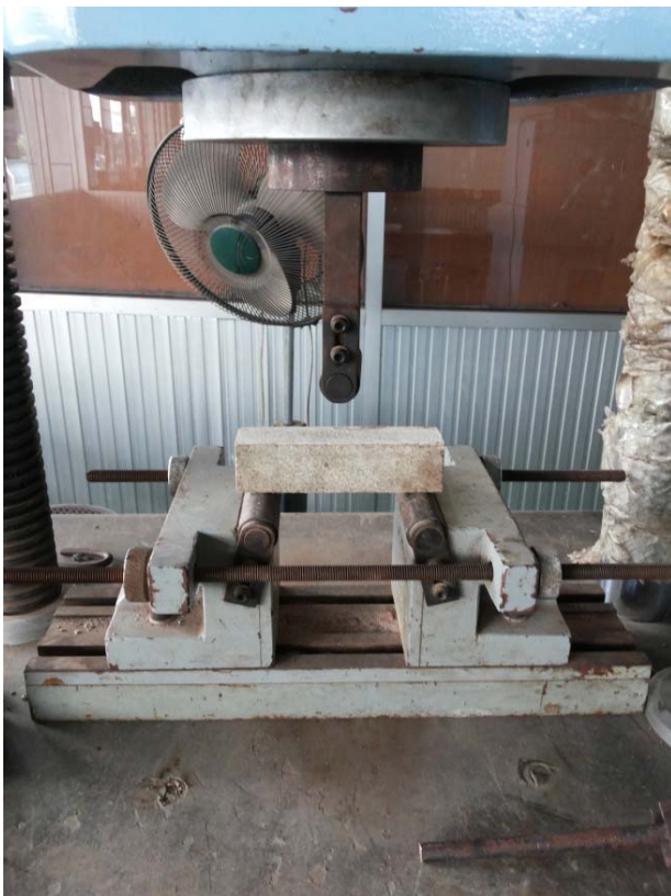
รูปที่ 44 ลักษณะการพังทลายของมอร์ตาร์ผสมโฟม EPS กำลังรับแรงค้ำ
