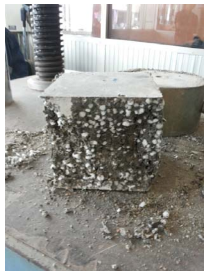
รูปที่ 43 ลักษณะการพังทลายของมอร์ตาร์ผสมโฟม EPS กำลังรับแรงอัด
