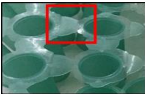
รูปที่ 5 ครีบบนชิ้นงาน
