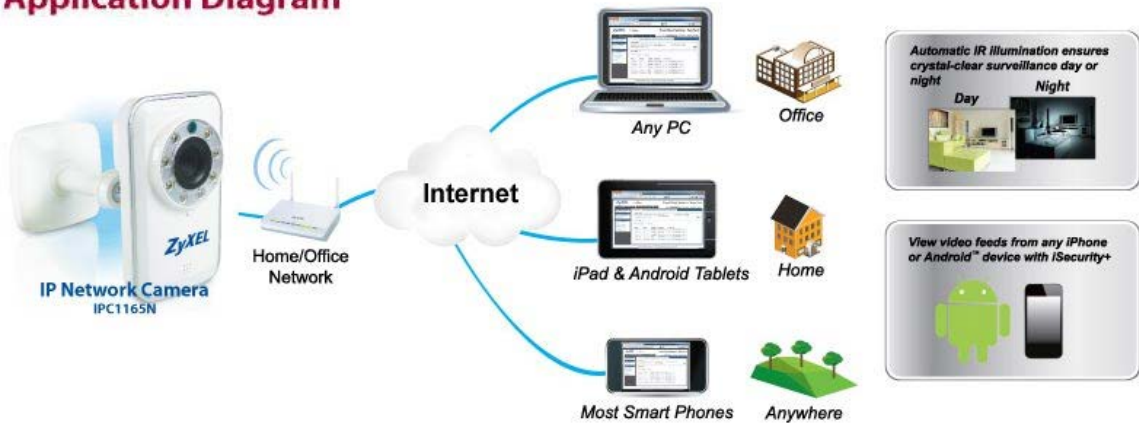
รูปที่ 2.1 โครงสร้างการทำงานของระบบกล้องวงจรปิด
