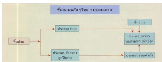
รูปที่ 2.5 ขั้นตอนหลักๆ ในการประกอบรถ
