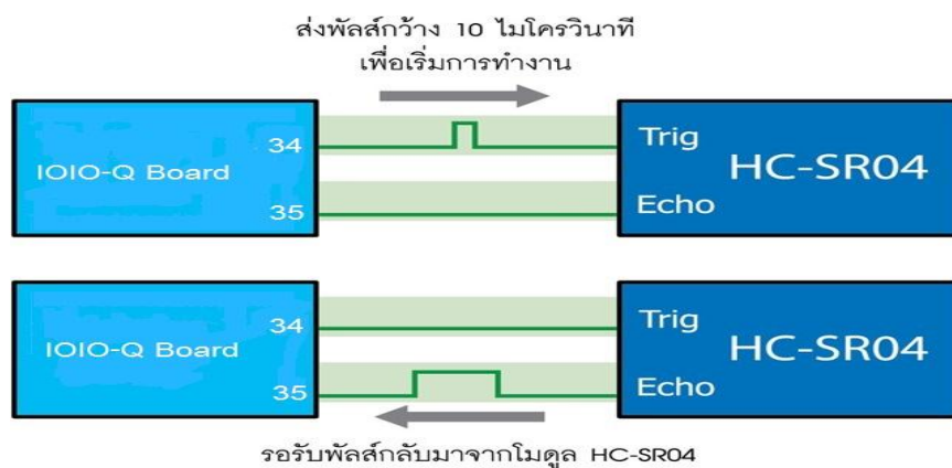
รูปที่ 2.12 แสดงการติดต่อระหว่างบอร์ด IOIO-Q กับโมดูล HC-SR04 เพื่อวัดระยะทาง
