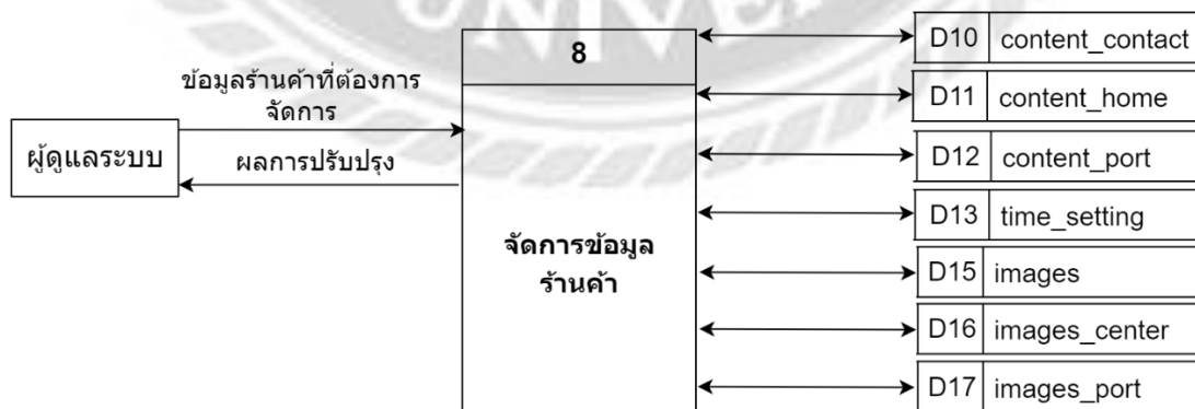
รูปที่ 3.11 Data Flow Diagram Level 1 ในส่วนของจัดการข้อมูลร้านค้า
