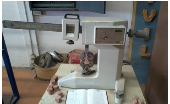
รูปที่ 3 การทดสอบกำลังรับแรงดึงดินซีเมนต์ผสมน้ำยางพารา
