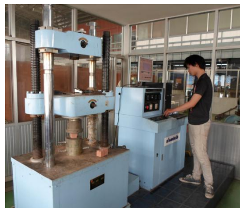
รูปที่ 1 ทดสอบกำลังรับแรงอัดดินซีเมนต์ผสมน้ำยางพารา
