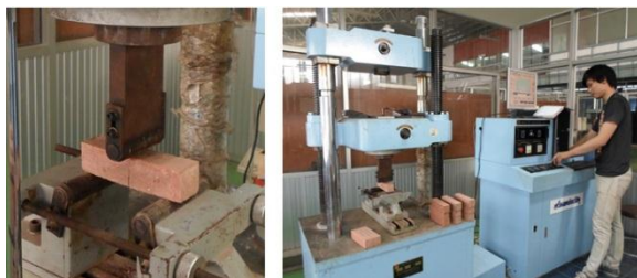
รูปที่ 2 ทดสอบกำลังรับแรงดัดดินซีเมนต์ผสมน้ำยางพารา
