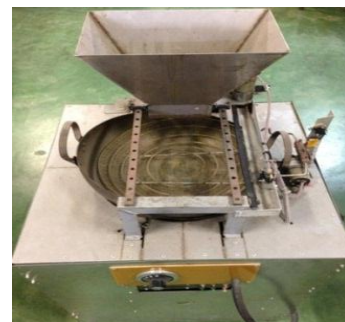
รูปที่ 7 เครื่องผลิตฝอยทองควบคุมโดยไมโครคอนโทรลเลอร์ที่สมบูรณ์
