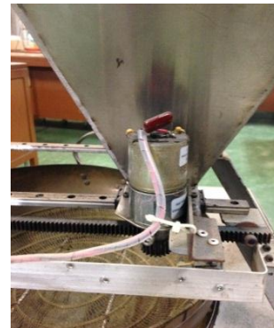
รูปที่ 6 คีชีมอเตอร์ 12 โวลต์ขับเฟืองชุดหยอดวัตถุดิบ
