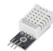
รูปที่ 3 เซ็นเซอร์วัดความชื้นและอุณหภูมิ [8]
