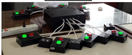
รูปที่ 7 การต่อ Controller Box กับ Display Box และ Sensor Box
