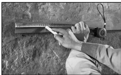
รูปที่ 4 แสดงการวัดความยาวชิ้นงานด้วยตลับเมตร
