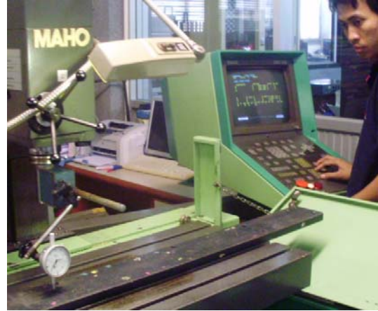
รูปที่ 9. ตรวจสอบความตรงความเรียบบนแท่นด้วยนาฬิกาเทียบศูนย์
