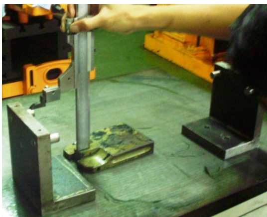
รูปที่ 8. ตรวจสอบความสูงของเดือยทั้ง 2 ตัว ด้วยเวอร์เนียไฮเกจ บนโต๊ะระดับ
