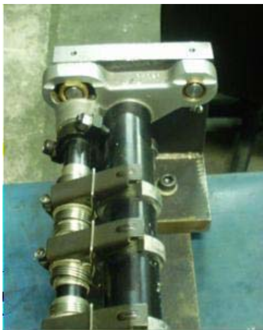
รูปที่ 11. แสดงการจับยึดของเครื่องมือกับตัวเรือนรองเพลลา
