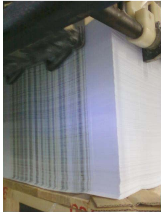
รูปที่ 12. กระดาษจากหน่วยพิมพ์มีความเรียบดี ด้านข้างทั้งสองข้างเรียบไม่มีรอยยับ
