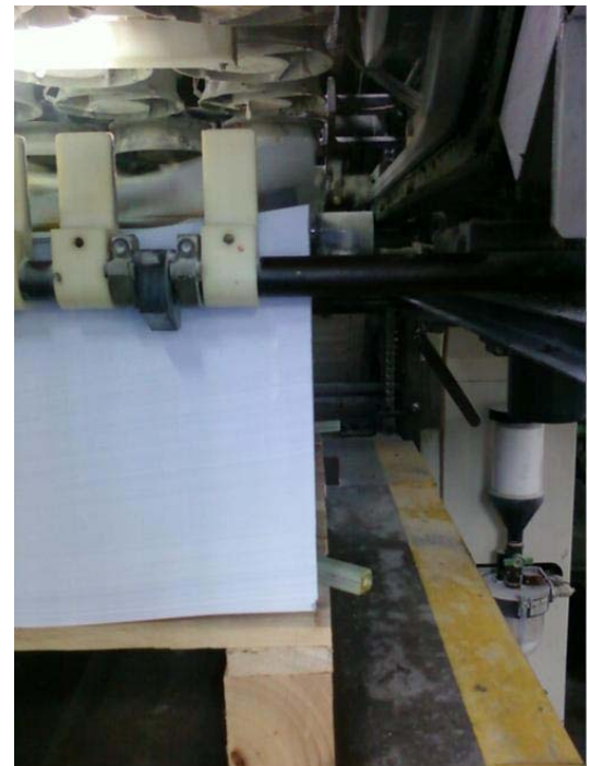
รูปที่ 13. ด้านหน้าของกระดาษไม่มีรอยฉีกขาดจากปากกราวกริปเปอร์พากระดาษ
