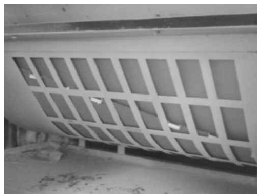
รูปที่ 2. กระดาษขาดและหลุดที่เกิดจากราวกริปเปอร์พากระดาษไม่สมดุลกันระหว่างตัวเรือนรองเพลลา ด้านซ้ายกับด้านขวา
