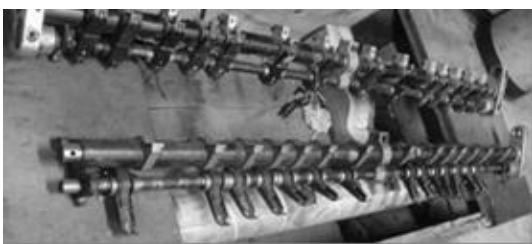
รูปที่ 1. ราวกริปเปอร์พากระดาษ (delivery gripper) ทั้งเพลลาและตัวเรือนรองเพลลาที่ถอดแยก
