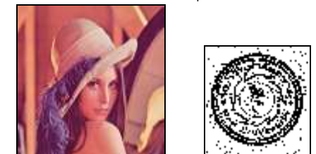
รูปที่ 21 ผลการถอดสัญญาณลายน้ำดิจิทัลเมื่อใช้วิธีแบบเปรียบเทียบค่าเฉลี่ย DCT 1 จุด ที่ค่า k = 1
