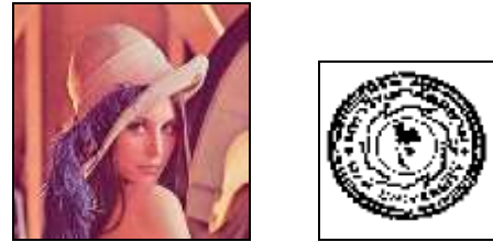
รูปที่ 18 ผลการถอดสัญญาณลายน้ำดิจิทัลเมื่อใช้วิธีแบบเปรียบเทียบค่าเฉลี่ย ที่ค่า k = 100
