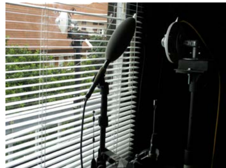
รูปที่ 6 หัววัดอุณหภูมิโอเปอร์เรทีฟ และเครื่องวัดรังสีแสงอาทิตย์แบบรวม ที่ติดตั้งอยู่ในห้องทดลอง
