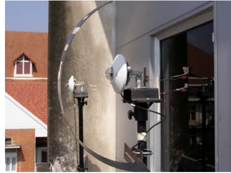
รูปที่ 5 เครื่องวัดรังสีแสงอาทิตย์แบบรวม และแบบกระจายภายนอกห้องทดลอง
