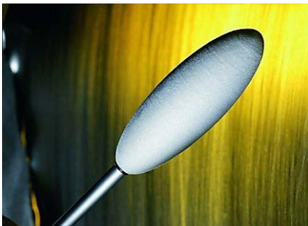
รูปที่ 3 หัววัดอุณหภูมิโอเปอร์เรทีฟที่อยู่ในตำแหน่งจำลองสภาพนั่ง
