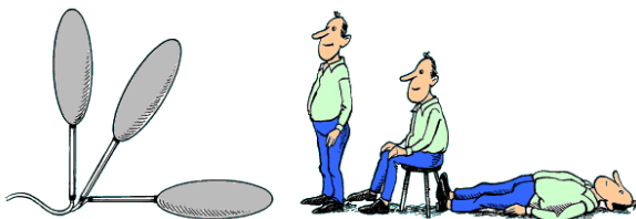
รูปที่ 4 ตำแหน่งของหัววัดอุณหภูมิโอเปอร์เรทีฟที่มุมเอียงต่างๆ ที่จำลองลักษณะของคน [8]
