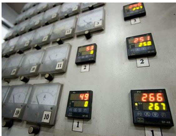
รูปที่ 6 การปรับตั้งค่าการทำงานของเครื่องขึ้นรูป
