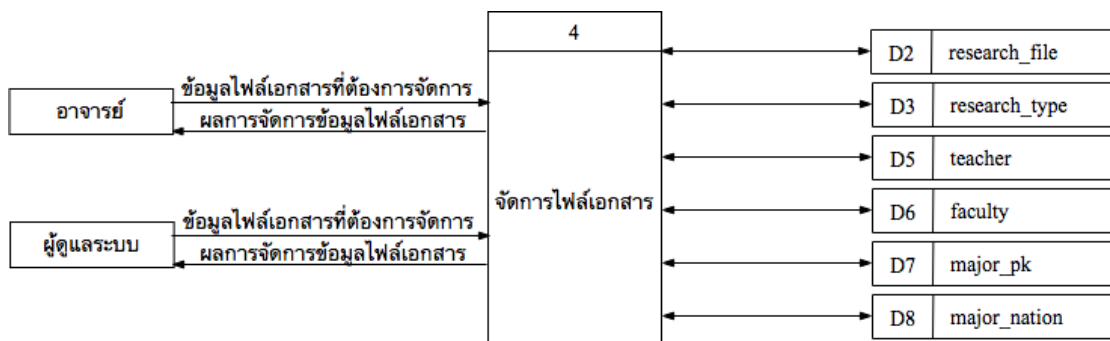
รูปที่ 3.7 Data Flow Diagram Level 4 ส่วนของการจัดการไฟล์
